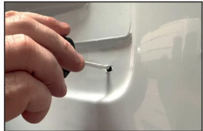
4. Rostschutz an den Bohrlöchern auftragen und trocknen lassen.
