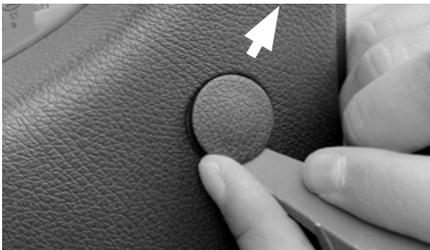
Lösen Sie die sich darunter befindliche Torx-Schraube TX 20.
