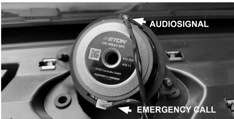
Sollte Ihr Fahrzeug über kein von Werk aus vorhandenes Audiosignal für den Centre Lautsprecher verfügen, ist dieses mittels eines zusätzlichen Verstärkers oder einem DSP-Verstärker herzustellen. Ihr ETON Fachhändler berät Sie hierzu gerne.
