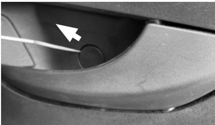
Lösen Sie die darunter befindliche Torx-Schraube TX20.
