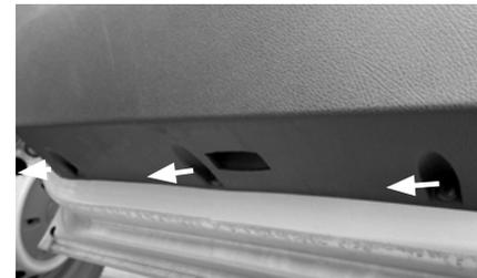
Eventuell abgebrochene Halteclips, Spreizdübel oder andere Halter ersetzen Sie bitte durch Neue.
