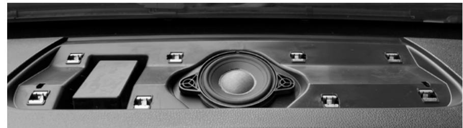
Entfernen Sie danach den Centrelautsprecher mit einem Kunststoffhebel. Der Lautsprecher ist mit einem Haltepunkt links und rechts in der mitte gesichert. Hebeln Sie den Lautsprecher nach oben hin aus und stecken Sie die beiden Audiokabel ab.
