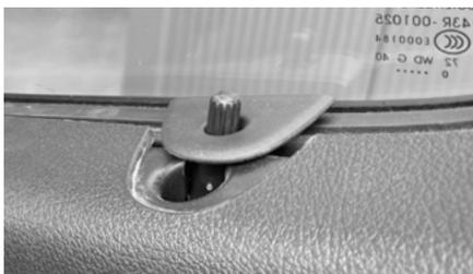
Sind alle Clipse entriegelt und gelöst, pressen Sie den Türpin im oberen Bereich der Türverkleidung heraus. Drücken Sie hierzu den Türpin zusammen mit der Halteplatte von sich weg, Richtung Scheibe.
