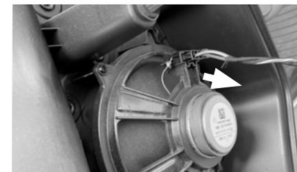
Lösen Sie alle elektrischen Verbindungen (Stecker Fensterheber, Beleuchtung, Lautsprecher).
